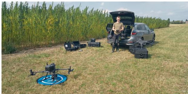
Der komplette Feldaufbau: Fluggerät, Sensorik, Steuerung, Akkus und Transporttechnik.
